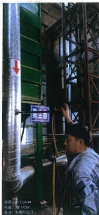
高压辊磨机废气布袋除尘器出口
